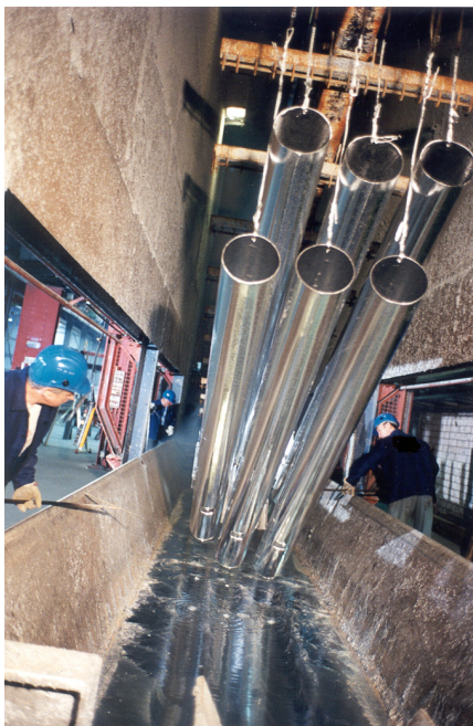
Bild 2: Verzinken von Stahlrohren [Institut Feuerverzinken], thermisches Spritzverzinken von Gasflaschen
