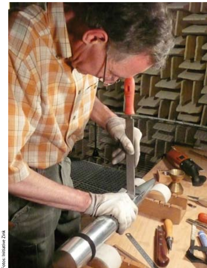
Unter höchster Genauigkeit werden die Feinkorrekturen an der Zinkpfeife ausgeführt.
